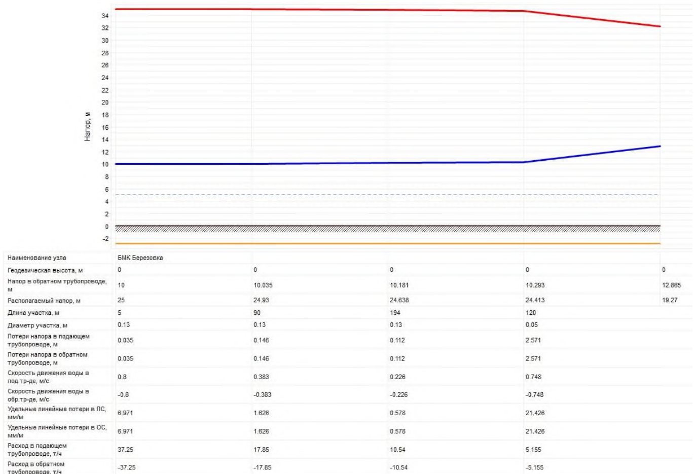
Рисунок 2.20 – Пьезометрический график от источника теплоснабжения (БМК п. Березовка) до административного здания в аварийной ситуации
